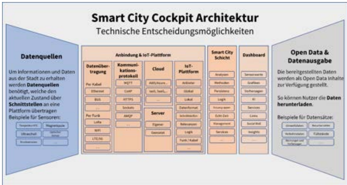
Abbildung 16: Smart City Architektur - Technische Ebene
